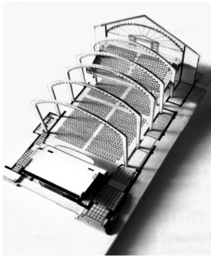
Fig.31 - Maquete de Daniel Villalobos. Estrutura concebida onde vai ser construída, posteriormente, a parede que vai definir a volumetria do espaço Fonte: http://recortable.danielvillalobosalonso.com/cinescala/
