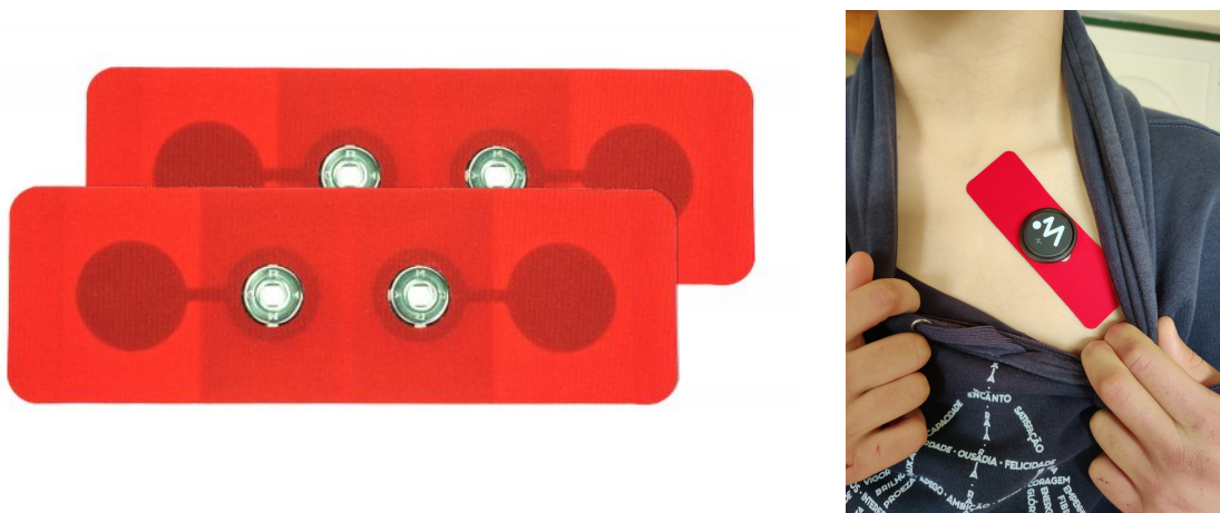
Figura 2 - Eletrodo adesivo e colocação do mesmo em conjunto com o sensor.
