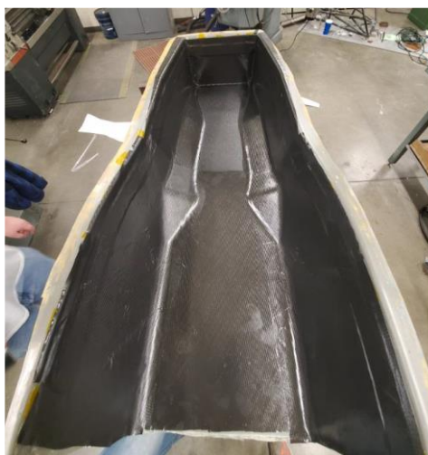
Figura 3.24: Primeira camada de Prepreg sobre o molde [44].
