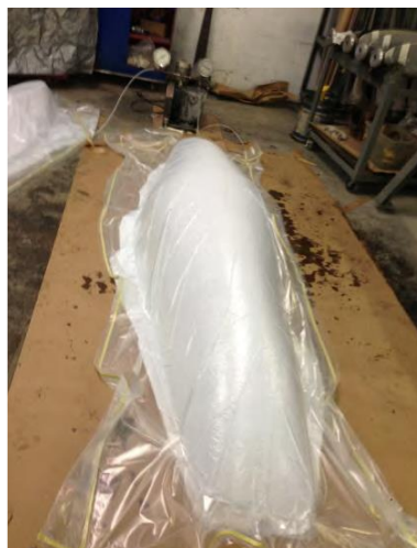
Figura 3.17: Saco de vácuo aplicado ao molde [42].
