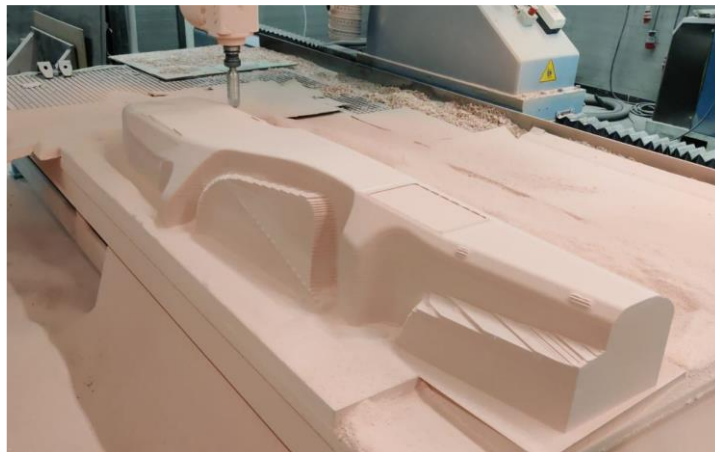
Figura 3.18: Molde macho em maquinação [29].
