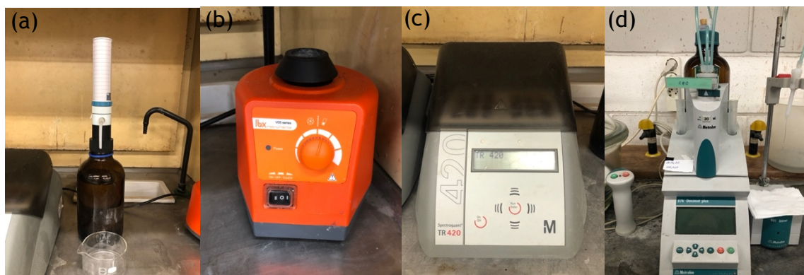
Figura 3.1 - Material utilizado na realização do teste de COD: (a) Socorex calibrex 520, (b) V05 series Ibx instruments, (c) Merck Spectroquant TR 420, (d) Metrohm 876 Dosimat Plus.
