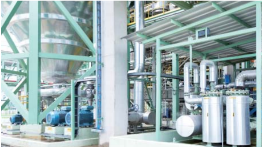
Figura 1.3: Aplicação do SynRM num misturador industrial [10].
