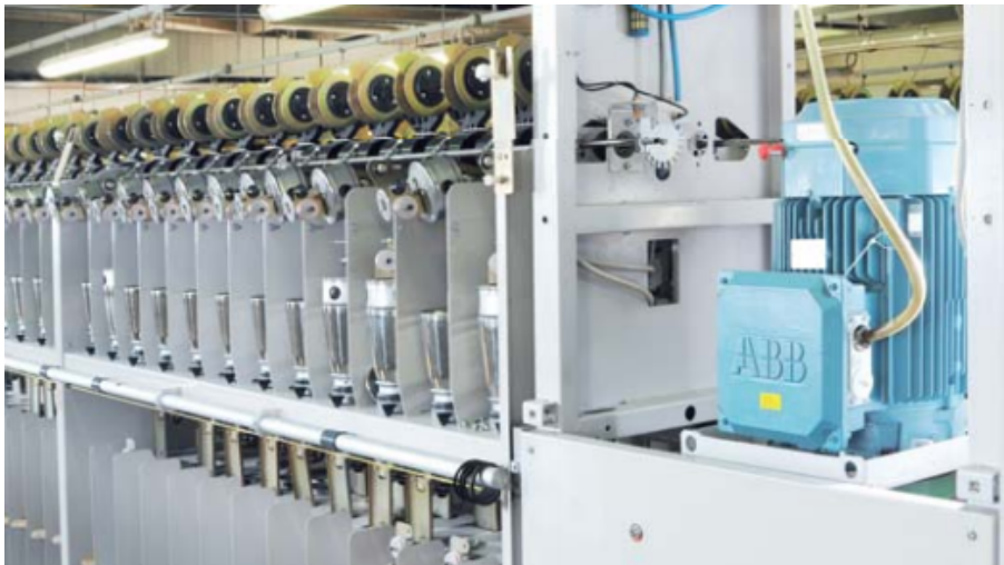
Figura 1.4: Aplicação do SynRM na indústria têxtil [10].
