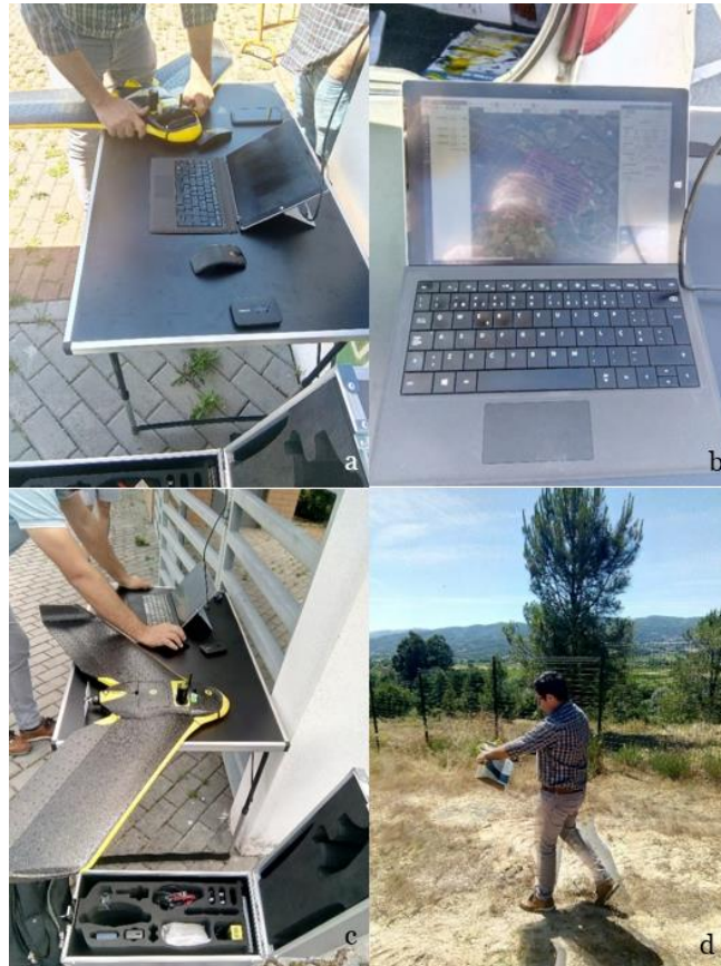
Figura 17 - a) montagem do drone; b e c) ficheiro com planeamento de voo; d) lançamento do drone em Belmonte.
