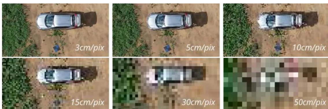
Figura 10 – Fotografia digital com diferentes resoluções
