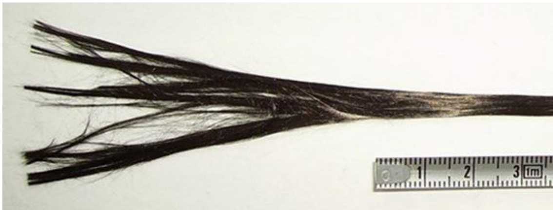
Figura 2.3 - Um feixe ( tow ) de fibra de carbono composto por milhares de filamentos [26]
