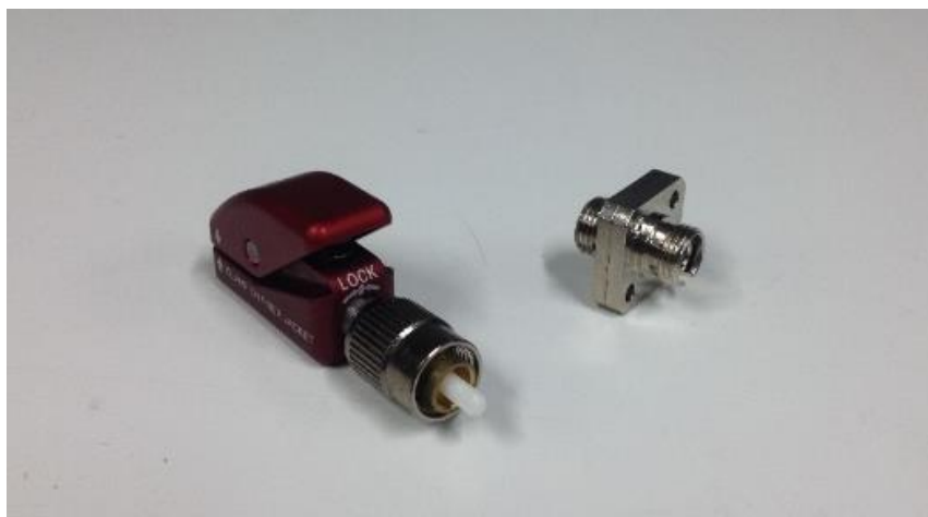
Figura 3.6 - Adaptadores macho e conectores fêmea usados no circuito
