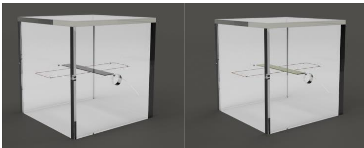
Figura 3.10 - Representação em 3D da câmara térmica com os provetes de carbono e fibra de vidro
