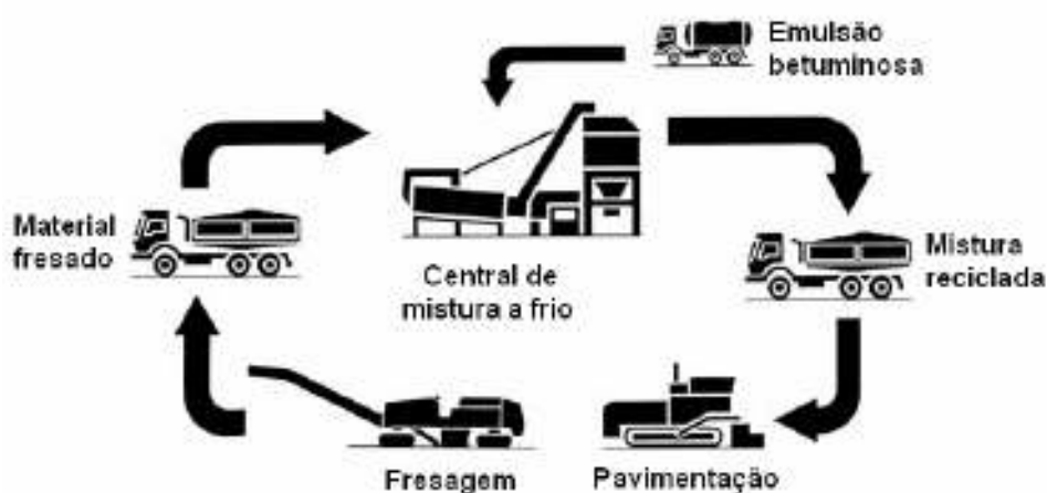
Figura 2. 4: Esquema do processo de reciclagem em central com emulsão betuminosa Fonte: Baptista (2006, p. 15)
