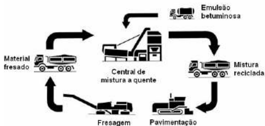
Figura 2. 15: Esquema do processo de reciclagem semi-quente em central Fonte: Baptista (2006, p. 16)
