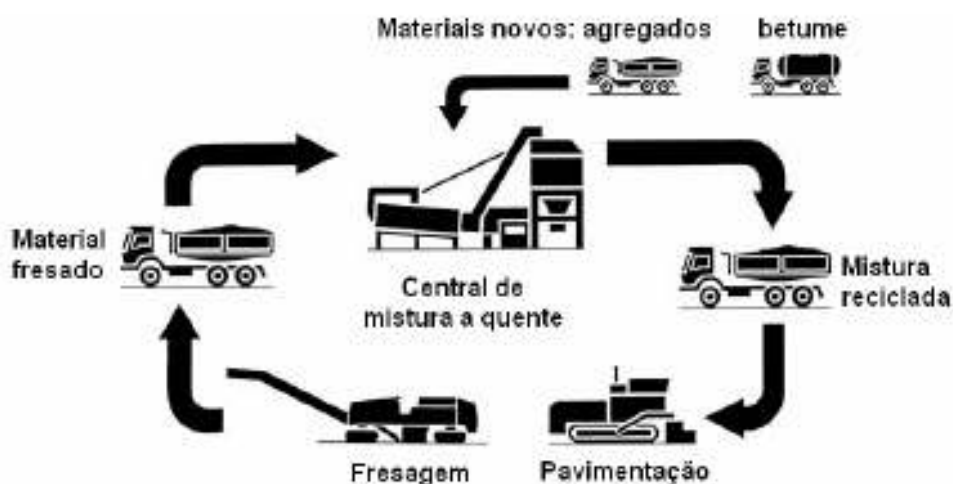
Figura 2. 9: Esquema do processo de reciclagem a quente em central Fonte: Baptista (2006, p. 17)
