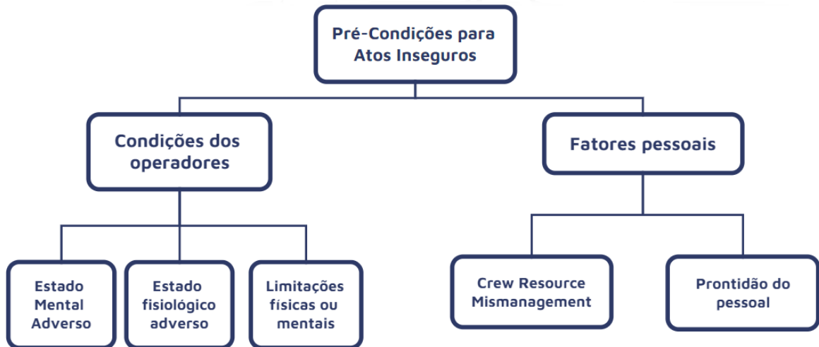
Figura 14. Esquema da Categoria das Pré-Condições para Atos Inseguros. Fonte: elaboração própria, com base em [29].
