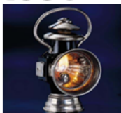
Fig. 3 - Lanterna a acetileno usada em carros da época. (Autoentusiastas, s.d.)
