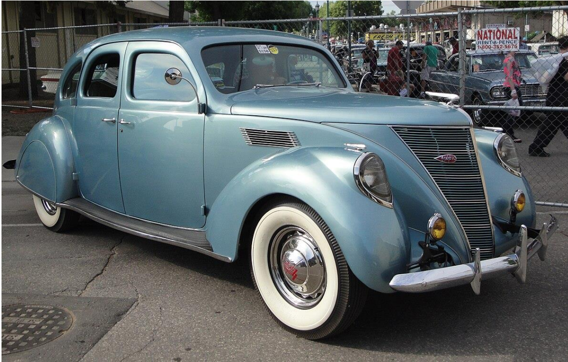
Figura 30 - Lincoln-Zephyr 1936, a primeira carroçaria monobloco (Wikipédia, s.d.).
