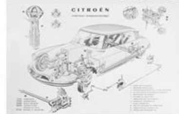
Fig. 20 - Esquema da suspensão hidropneumática na Citroen DS. (Mania das Kits, 2019)
