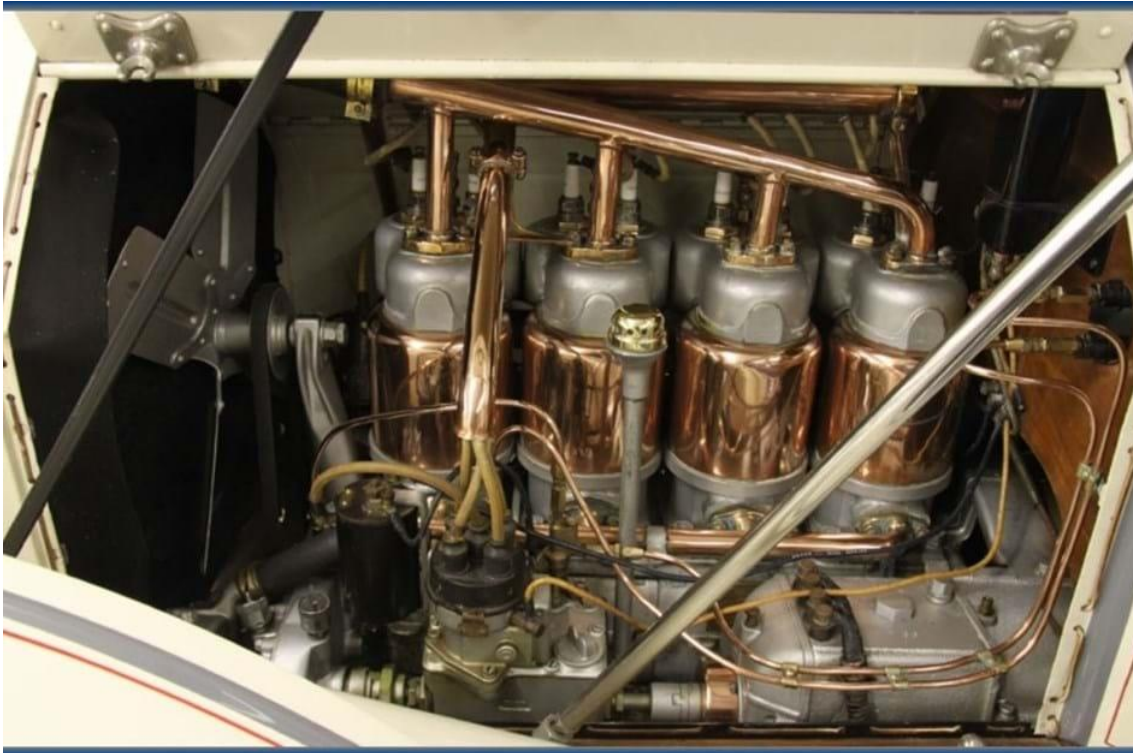
Figura 17 - Primeiro motor de arranque elétrico da Cadillac em 1912. O motor de arranque está situado ao longo da parte de fora do motor (Aquele Máquina, 2017).
