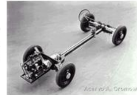
Fig. 8 - Chassis e tubo central com suspensão independente nas quatro rodas. (Gromow, Alexander, 2016)
