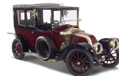
Fig. 4 - Renault 20hp com travagem em duas rodas, 1906 (Museu do Caramulo, s.d.)
