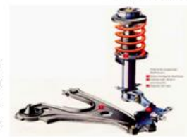
Fig. 18 - Esquema da suspensão McPherson. (Blog da Jocar, 2020)
