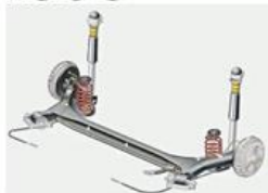
Fig. 11 - Exemplo de um sistema de suspensão independente de barra de torção. (Autotachki, 2022)
