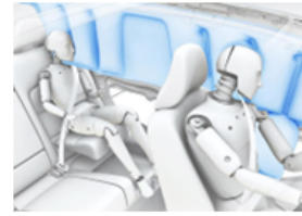
Fig. 28 - Esquema do funcionamento de um airbag lateral (Duarte, André, 2017)
