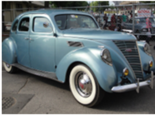
Fig. 5 - Lincoln-Zephyr 1936, a primeira carroçaria monobloco. (Wikipédia, s.d.)
