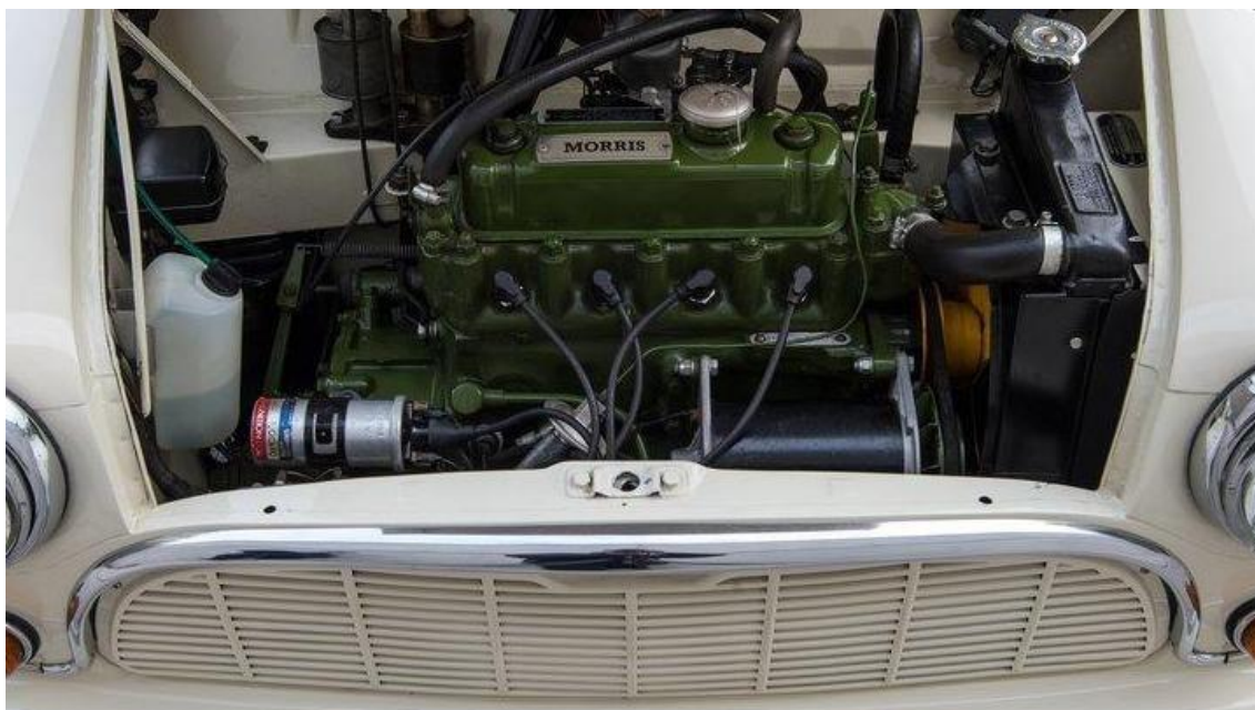
Figura 33 - Modelo Morris Mini de 1959, disposição do motor frontal transversal (HotCars, 2021).
