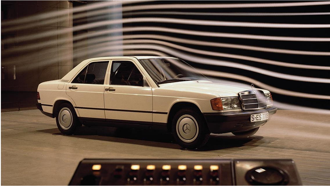
Figura 74 - Teste aerodinâmicos do Mercedes-Benz 190, 1982 (Revista ACP, 2017).
