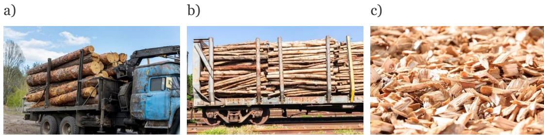
Figura 11 – Formas de entrada de madeira na fábrica: a) Troncos com casca; b) Troncos sem casca; c) Estilha
