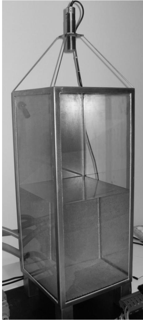
Figura 89 - Vista geral da tina de água construída para a simulação.
