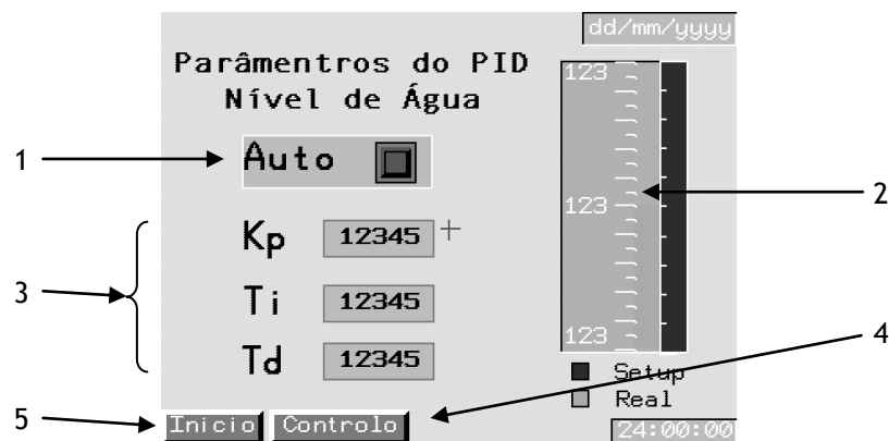
Figura 79 - Painel dos parâmetros do PID Nível de água, referente ao controlo de nível da água na câmara de carga.
