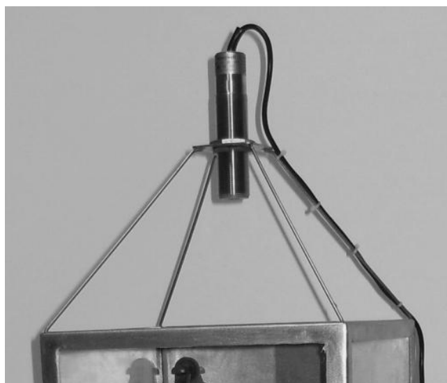
Figura 90 - Suporte do sensor Ultra-sónico.
