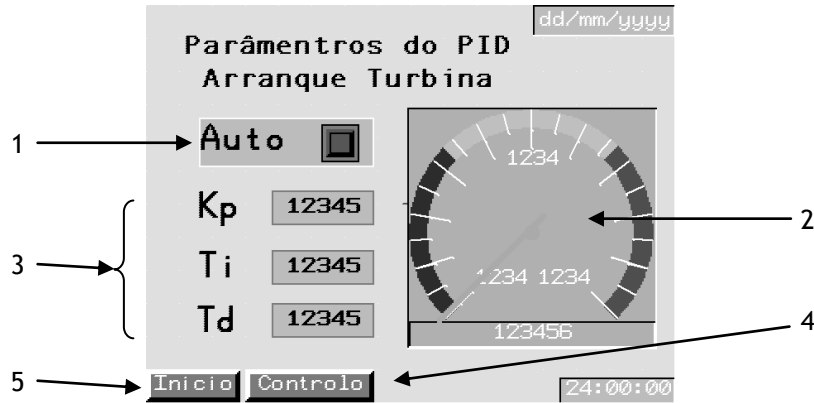
Figura 80 - Painel dos parâmetros do PID Arranque turbina, referente ao controlo da rotação da turbina no arranque.
