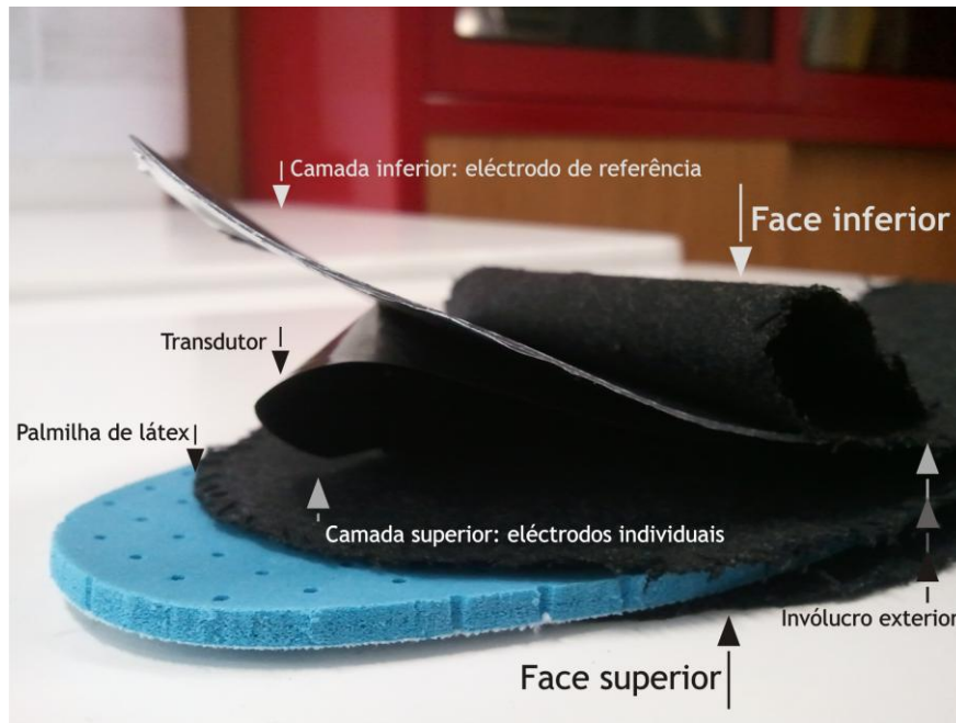
Fig. 35 - Camadas do protótipo de baixa resolução. O protótipo aparece sem a camada superior de eléctrodos e numa orientação contrária àquela em que será utilizado por motivos de clareza da imagem.
