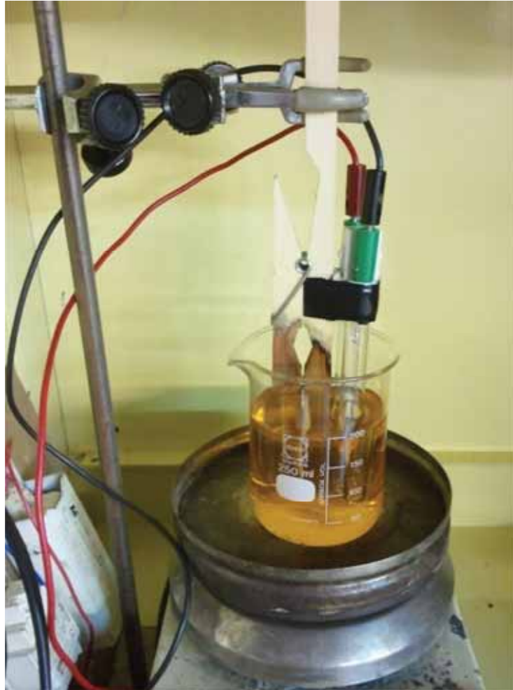
Figura 3.4 - Montagem efetuada durante os ensaios de degradação fotocatalítica com os filmes de óxidos tipo perovesquite
