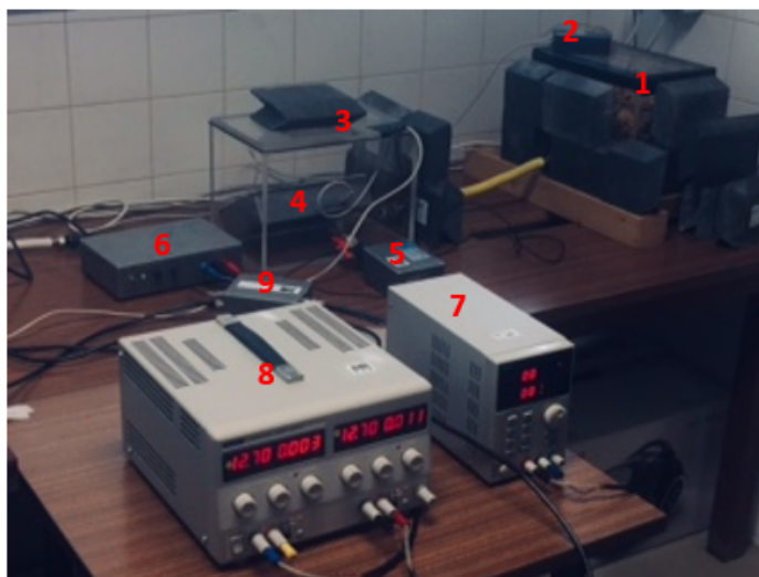
Figura 7.10: Dispositivo experimental para testes do protótipo num ambiente rico em radão. (1) fonte de radão - caixa com rochas, (2) Arduino ligado ao sensor BME280, (3) caixa de acrílico contendo (4) protótipo, (5) detetor S3590-09, (6,8,9) fontes de alimentação, (9) Pré-amplificador.
