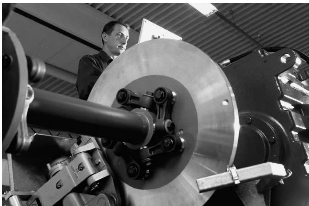
Figura 3.15 – Travão mecânico do eixo de alta velocidade [Burton01].
