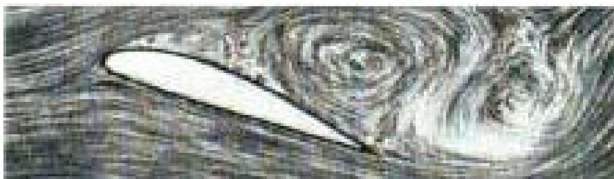
Figura 4.2 – Fluxo separado ( stall ) em volta do perfil [Brito06].
