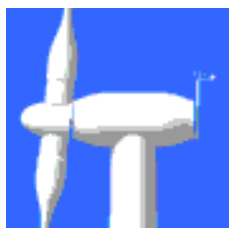
Figura 3.5 – Tilt angle de um rotor com duas pás [Castro09].
