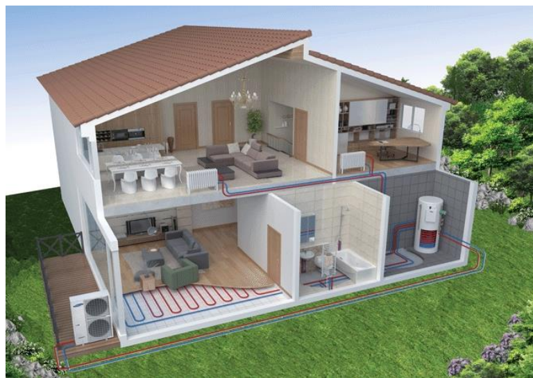
Figura 3.5 Sistema de bomba de calor ar-água.
