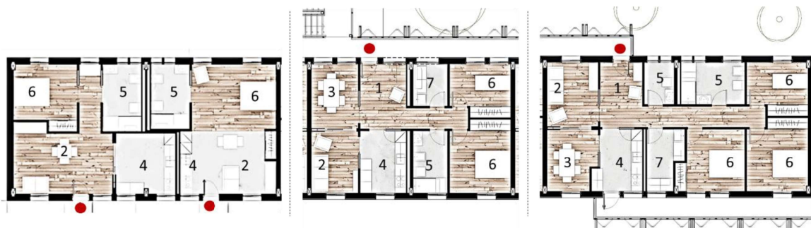
Figura 8 - Planta de tipologia T1+ T0, T2 e T3 (respetivamente). Legenda: 1-Entrada, 2-Sala de estar/comum, 3-Sala de jantar, 4-Cozinha, 5-Instalação sanitária, 6-Quarto, 7-Lavandaria.
