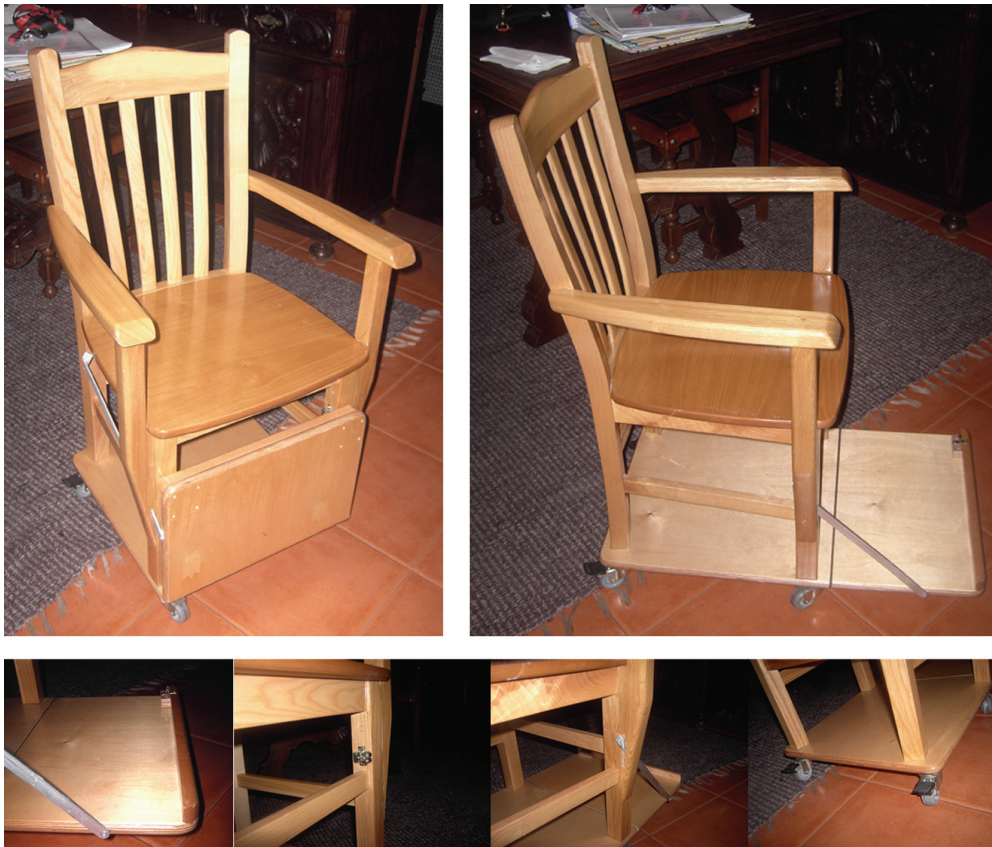
Figura 8.1 Cadeira de rodas em madeira feita por um familiar do participante C2.
