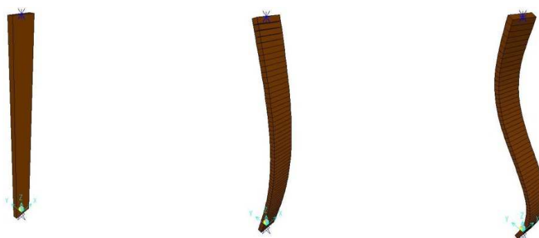
a) Modelo indeformado b) 1 o modo de encurvadura c) 2 o modo de encurvadura
