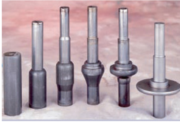
Fig. 1.3.6.4.c – Exemplo de uma peça fabricada em 5 estações; (Fonte: ACUMENT GLOBAL TECHNOLOGIES – Cold Forming Specials).
