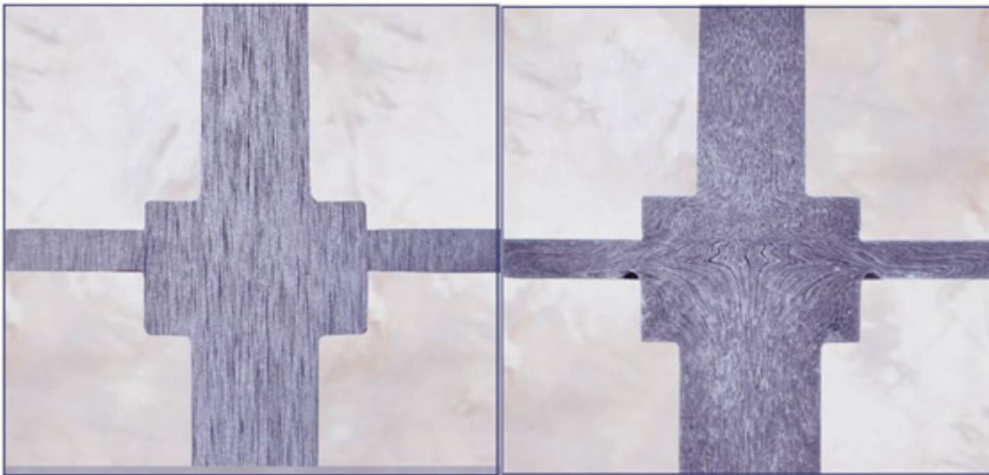
Fig. 1.2.a – Peça torneada (esquerda) e peça estampada a frio (direita); (Fonte: ACUMENT GLOBAL TECHNOLOGIES – Cold Forming Specials).
