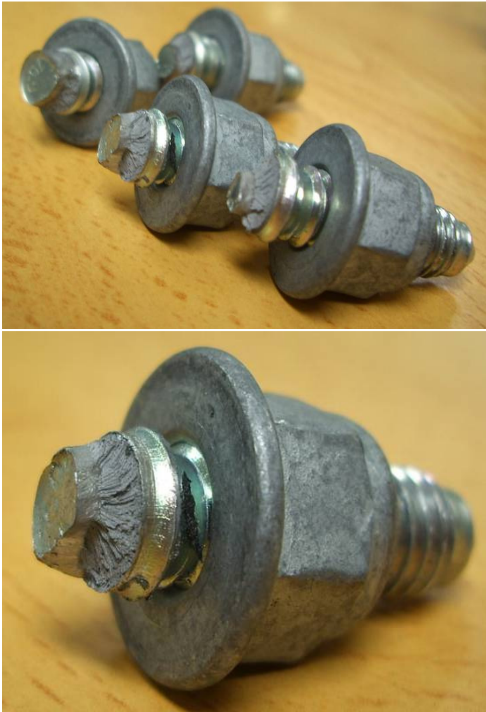
Fig. 5.1.d – Imagens / fotos de parafusos danificados na região entre a cana e a cabeça do parafuso; (Fonte: Servimetal, Análises Químicas – Físicos – Metalográficos – Investigación – Asesoramiento Metalúrgico, Cliente: FLEXNGATE ESPAÑA, S.A., 8/06/2007).
