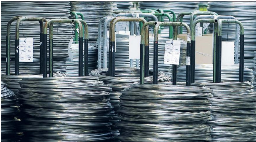
Fig. 1.1.d – Arame em Fio trefilado; (Fonte: José Manuel, Formação em Estampagem e Roscagem, Pecol II, 2008).
