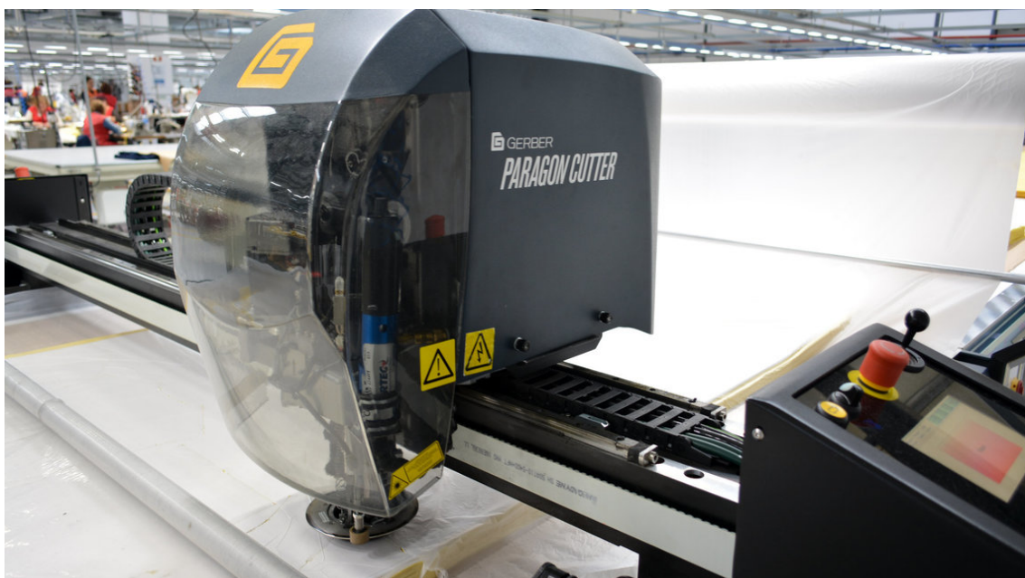
Figura 22. Mesa digital de corte de tecidos Fonte: Benoli, 2022
