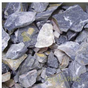
Fig. 39: Cascalho, usado no embasamento. [38]
