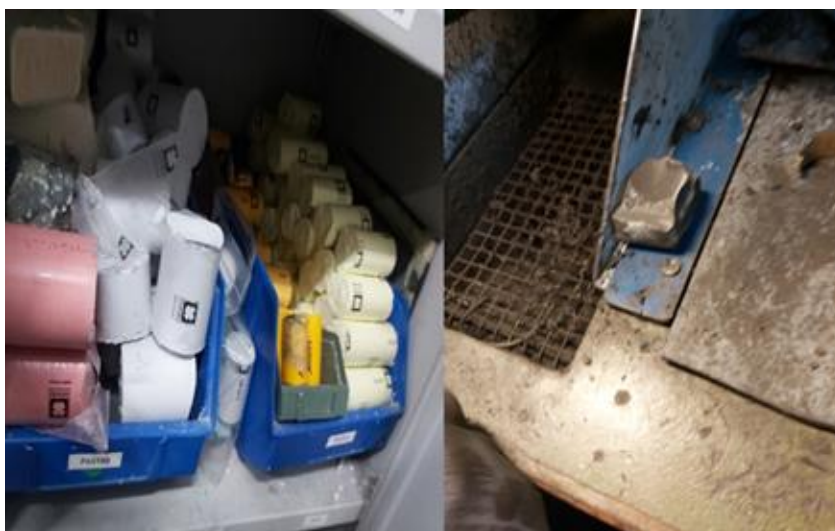
Figura 36 – Tipo de pastas utilizadas no processo de polimento, responsáveis pela sujeira e poeira resultante do processo de polimento.
