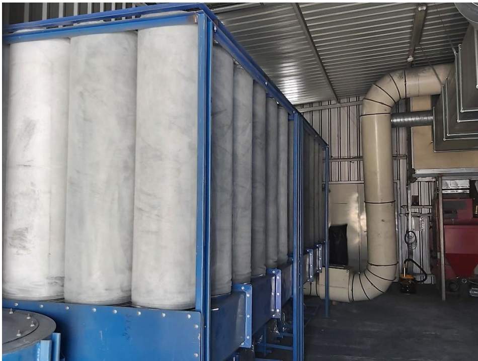
Figura 53 – Representação de material inflamável presente nos filtros do sistema de aspiração.
