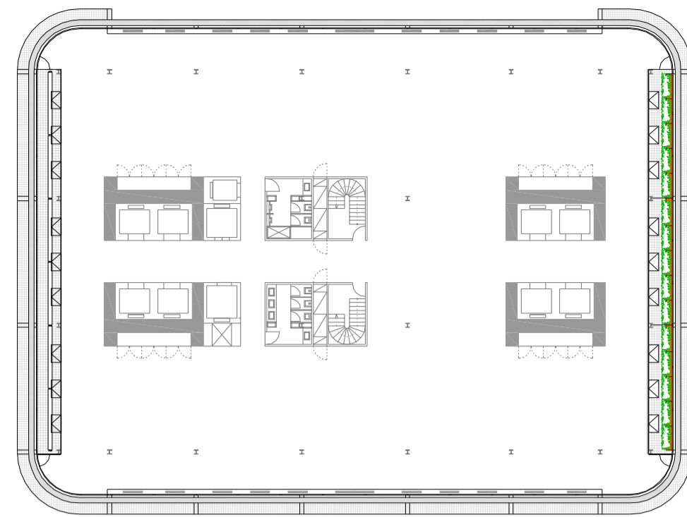
Planta tipo Intervenção: Eliminação dos indutores na fachada Este e Oeste Criação de duas câmaras de controlo solar e de climatização passiva
