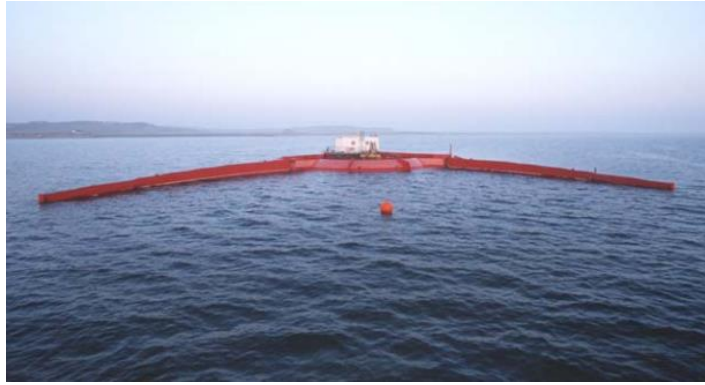
Figura 4.11: Central Wave Dragon em Nissum, adaptado de [61].
