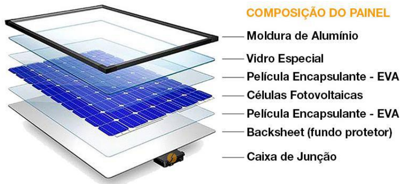
Figura 2.12: Representação da composição de um painel, adaptado de [43].
