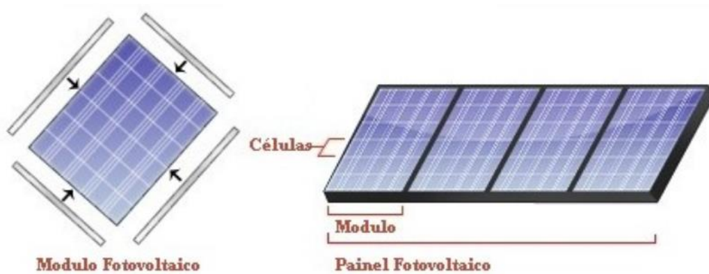
Figura 2.13: Representação de um módulo e arranjo fotovoltaico, adaptado de [44].
