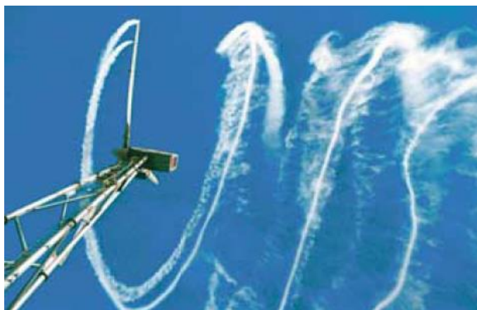
Figura 3.3: Efeito de esteira, adaptado de [43].
