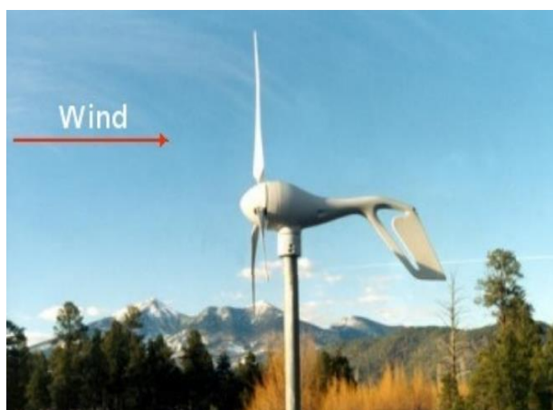
Figura 3. 9: Representação da opção "upwind", adaptado de [47].
