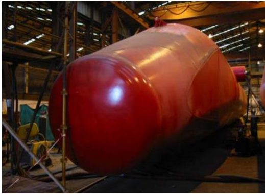
Figura 4.9: Protótipo de 750 kW, vista da parte frontal durante a construção (esquerda), reboque do dispositivo para o local de colocação (direita), adaptado de [61].
