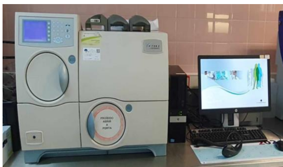
Figura 23: Equipamento VITEK®2 COMPACT usado no Laboratório de Microbiologia e cartas usadas para identificação e sensibilidade aos antibióticos [93]
