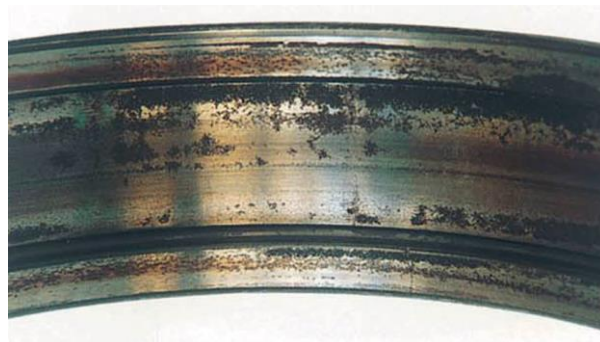
Figura 3.4 – Corrosão por humidade na pista do anel exterior [31].
