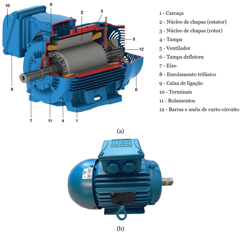
Figura 2.1 - Motor de indução trifásico: (a) Partes constituintes [14]; (b) Motor de indução utilizado nos ensaios experimentais.
