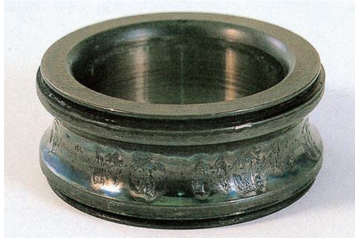
Figura 3.8 – Anel interno do rolamento radial de esferas [56].
