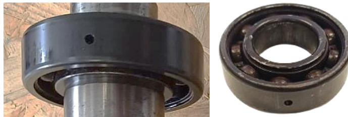
Figura 5.4 – Avarias 1 e 2 - furo de \text{Ø}2 mm na pista exterior nos rolamentos 1 e 2.
