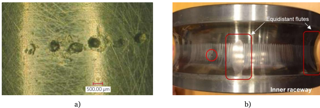
Figura 3.7 – a) Crateras de 0,5 mm de dimensão [32]; b) Danos na pista interior causada por erosão por fuga de corrente [50].
