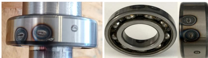
Figura 5.5 – Avaria 3 - pitting produzido por ED.
