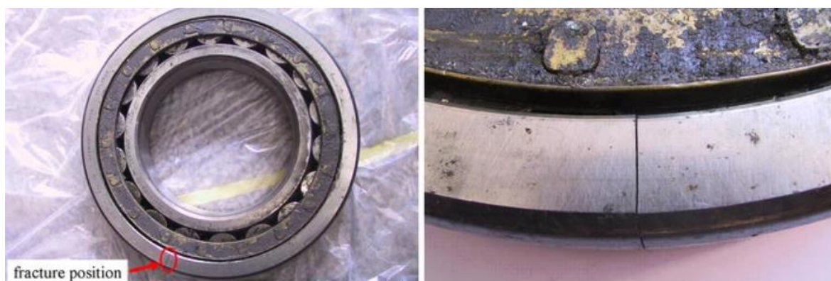
Figura 3.11 – Danos na pista exterior do rolamento devido a fissuras térmicas [61].
