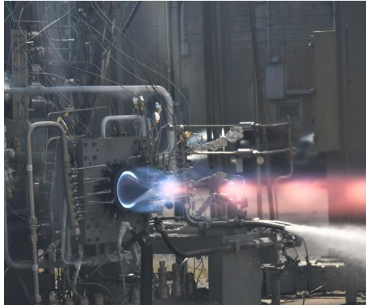
Figura 3.16: Testes do RDRE em grande escala, impresso em 3D, em 2022, na NASA em Huntsville, Alabama [48].
