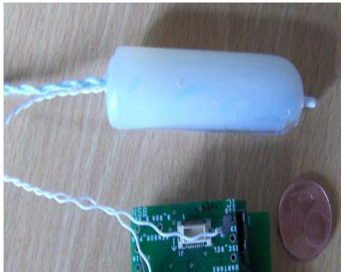
Figura 9- Termistor MA100 com o respectivo invólucro
