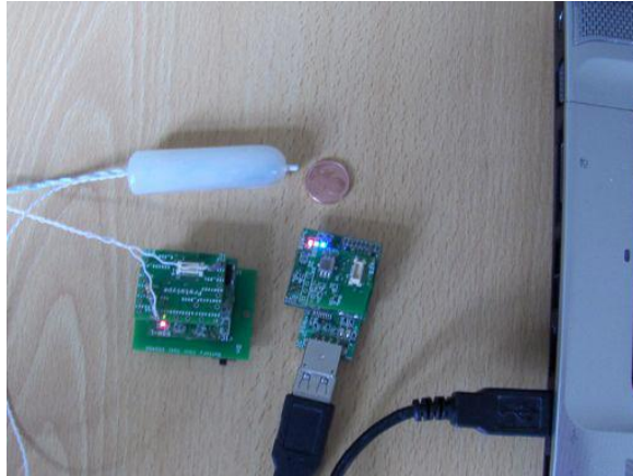
Figura 10- Sistema para recolha e monitorização da temperatura intra-corporal feminina
