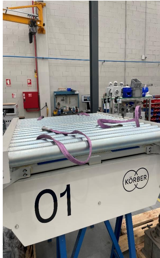
Figura 3.6 - Cintas da ponte mal armazenadas
