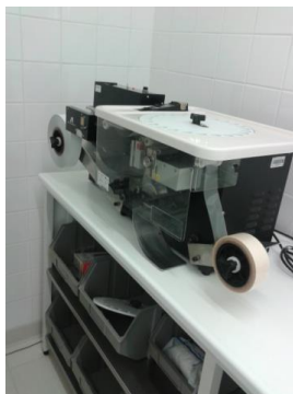
Figura 10 - Máquina de reembalagem e rotulagem dos SF da ULS da Guarda, HSM
