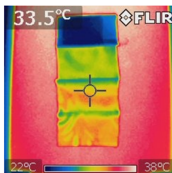
Figura 55 - Imagem térmica relativa ao comportamento das costuras. (Fonte: autor).
