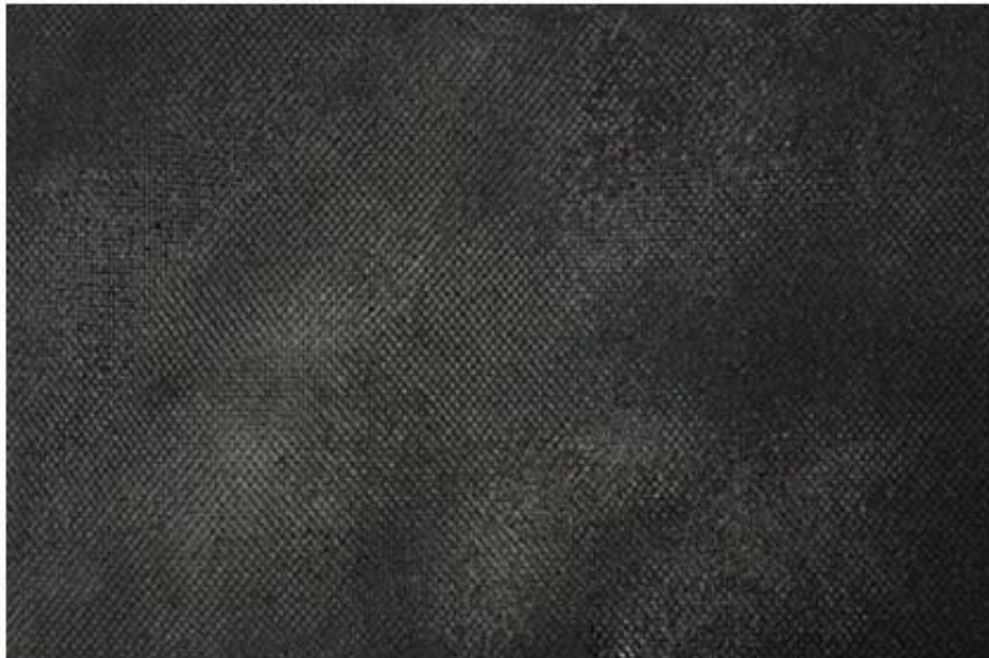
Figura 38 – Laminado obtido após um tempo de queima de 15 min a 400 °C.
