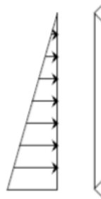
Figura 12 - Sistema estrutural de apoio dos muros de cave
