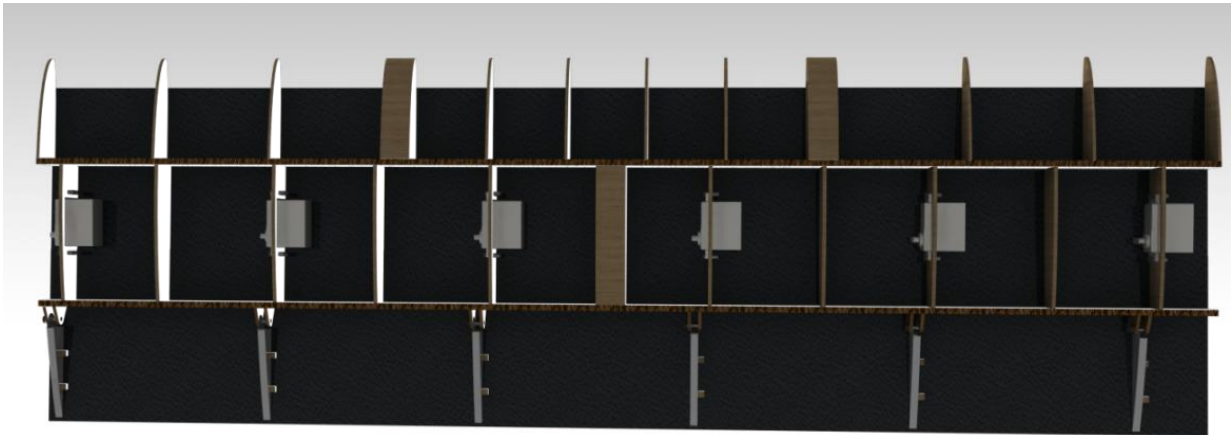
Figura 3 – Pormenor estrutural do modelo CAD (CATIA V5) da asa com o flape contínuo.
