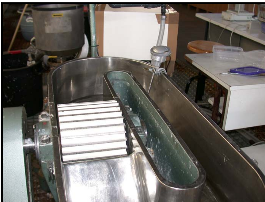
Figura 2-1 Refinador Valley laboratorial e desintegrador.
