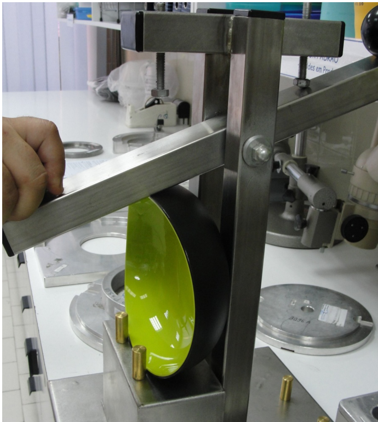
Fig. 7.8 – Teste de adesão entre duas camadas da mesma peça
