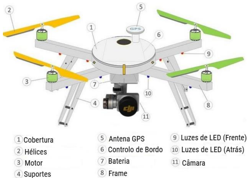
Figura 3.11: Esquema de um veículo aéreo não tripulado (Fonte: adaptado de Tatale et al., 2018).
