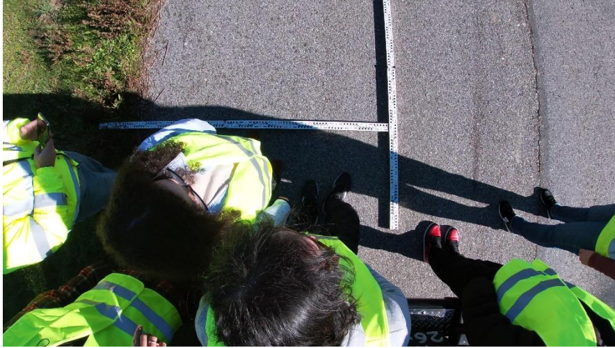
Figura 5.3: - Verificação da amplitude de captação de imagem na posição paralelo e perpendicular ao sentido de movimento do veículo.
