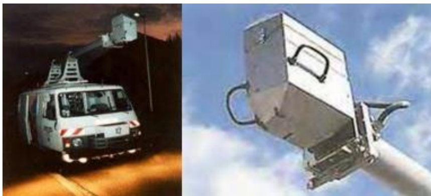
Figura 3.6: Veículo Gerpho e pormenor do equipamento fotográfico (Fonte: Nery, 2023).
