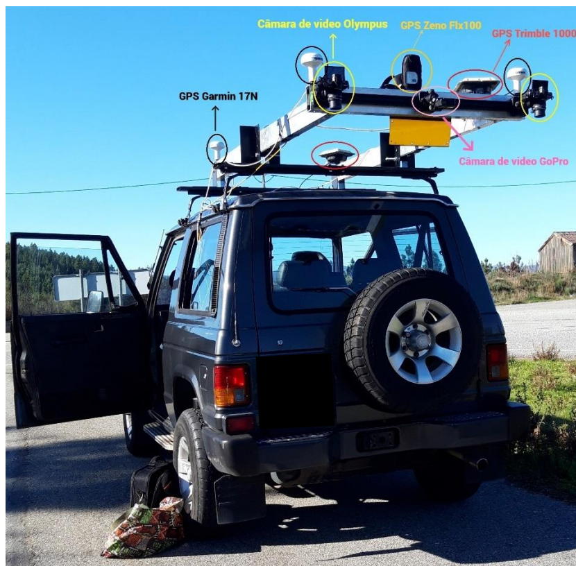
Figura 5.2: Equipamentos usados no levantamento de dados do pavimento e a sua disposição no veículo terrestre utilizado.
