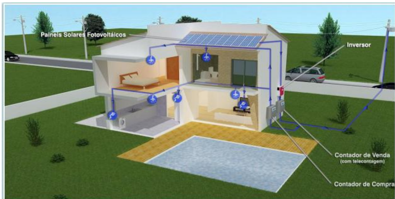
Fig.35. Esquema de um sistema Fotovoltaico Microprodutor [29]
