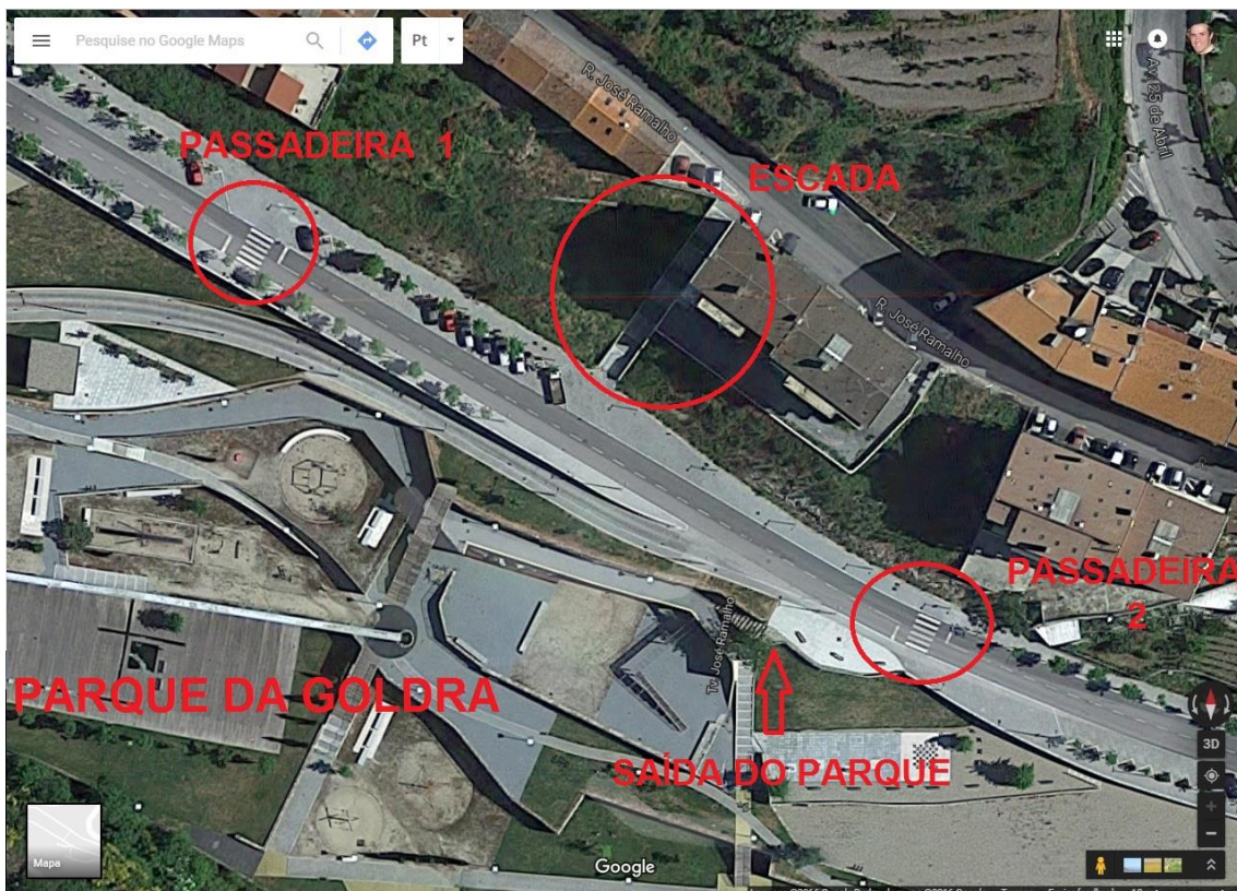
Ilustração 85 - A rua que leva ao elevador da Goldra é um exemplo de passadeiras mal posicionadas.
