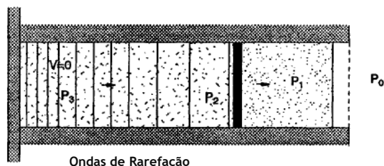
Figura 12. 3ª Fase do ciclo PDE: a onda de detonação propaga-se ao longo da câmara [15].
