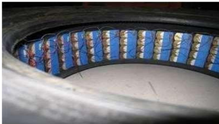
Figura 2.16 - Nano geradores piezoelétricos dentro do pneu.
