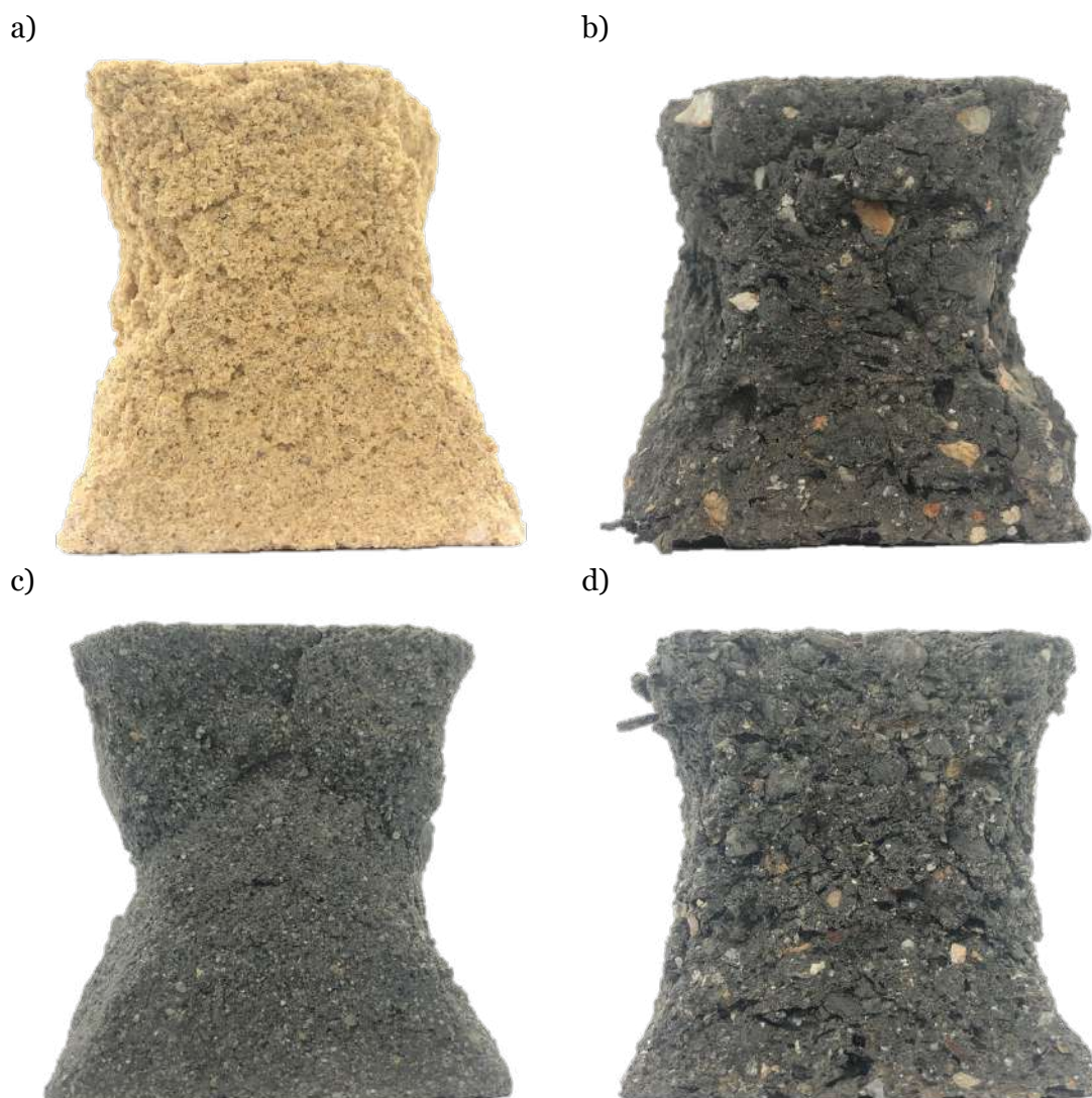
Figura 4-3 – CPs das composições (a) M.YS, (b) M.BS, (c) M.BSYS e (d) M.BSBS após ensaio de resistência à compressão.
