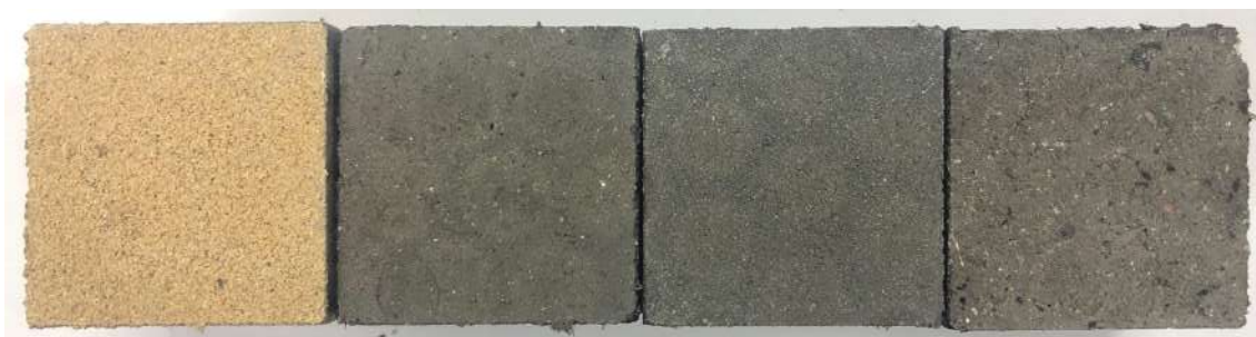
Figura 3-17 – Superfície inferior de um CP das misturas M.YS, M.YS, M.BS, M.BSYS e M.BSBS, da esquerda para a direita, logo após a cura por carbonatação acelerada.
