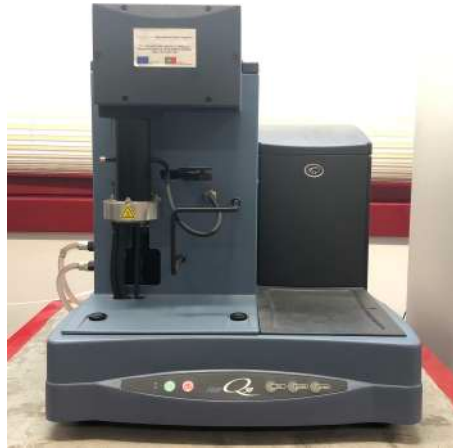
Figura 3-8 – (a) Equipamento para ensaio de termogravimetria SDT Q-50 (TA Instrument).
