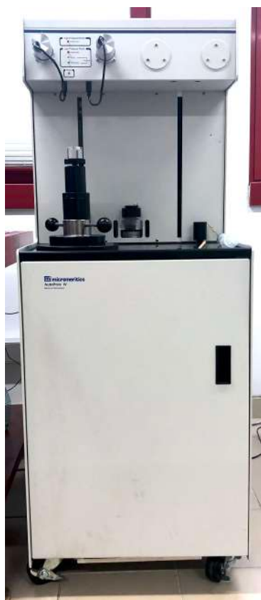
Figura 3-22 – Equipamento de porosimetria por intrusão de mercúrio modelo AutoPore IV 9500 V1.07 (Microporometrics).
