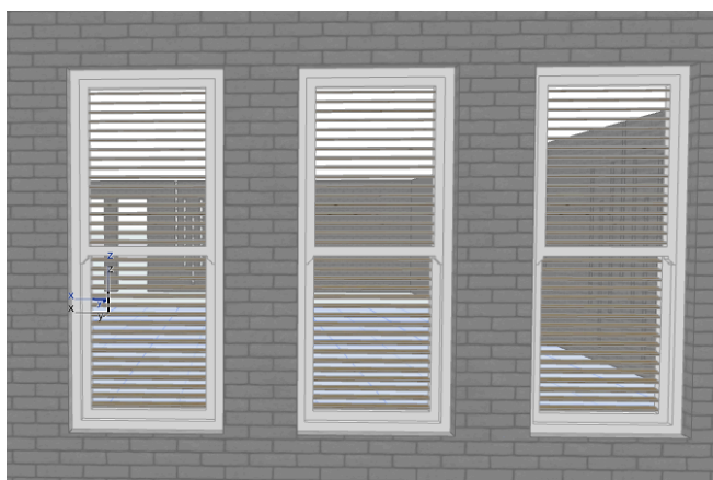
Figura 125 – Janelas ripadas com sistema de guilhotina (Fonte: Autora)
