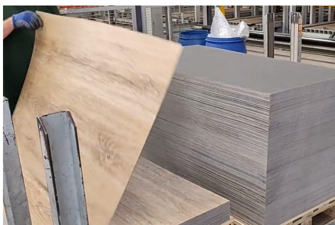
Figura 12-Viragem das placas de LVT
