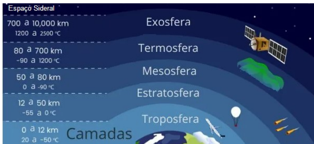
Figura 3 As ondas em radiofrequência atavessam diversas camadas até ao satélite [47]
