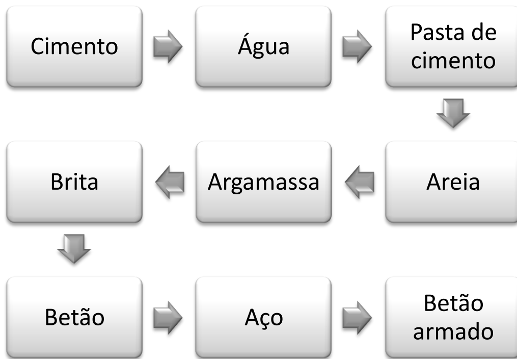
Figura 17 – Figuração esquemática da produção de betão.
