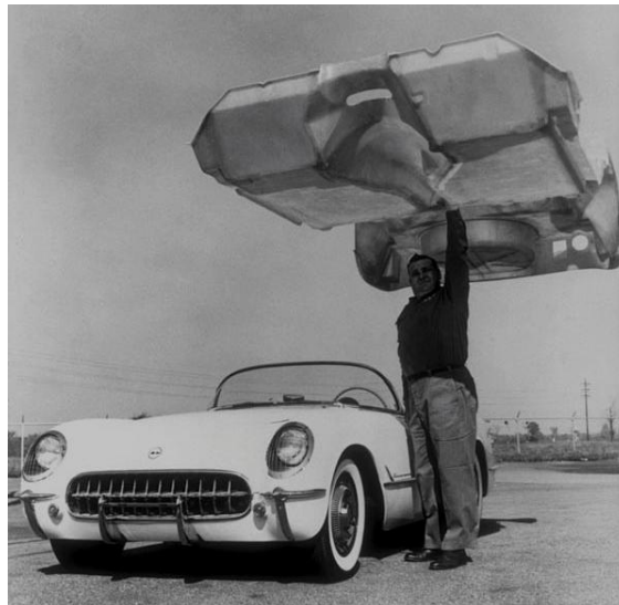
Figura 1.1 - Chassis do Corvette® C1 construído em fibra de vidro [10].
