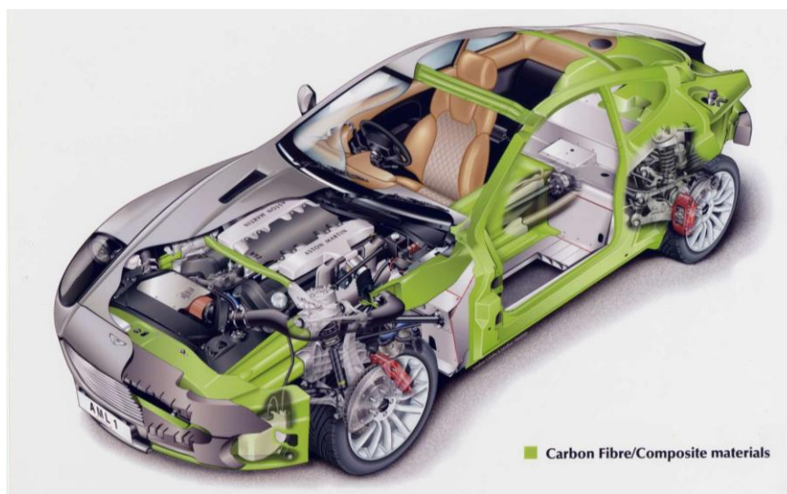
Figura 1.4 - Aplicação de materiais compostos na estrutura do Aston Martin V12 Vanquish [2].
