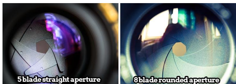
Figura 58 - Exemplo de diafragmas com uma quantidade diferente de lâminas e a forma como estes deixam a luz entrar (s/i).
