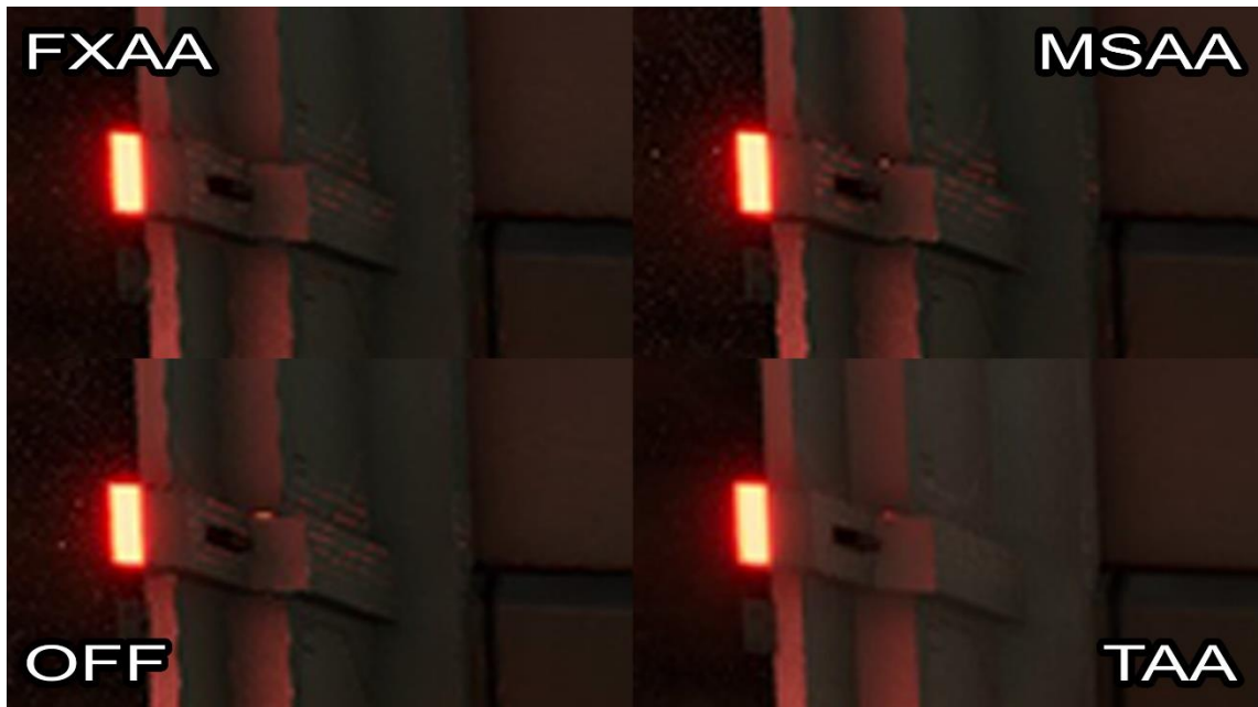
Figura 35 - Comparação entre as opções de AA disponíveis na Unreal Engine 4.26 (Imagem do autor).
