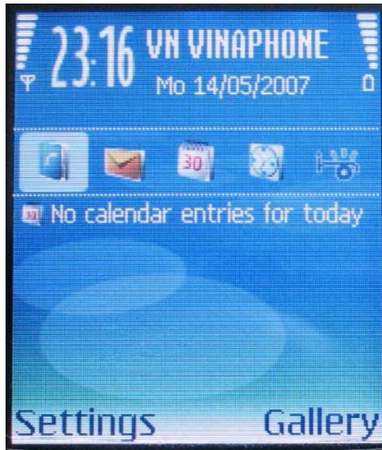
Figura 20 - Pormenor do ecrã de um Nokia N70 (Nokia, 2005), onde, se consegue observar o Aliasing dos vários objetos e textos do ecrã.
