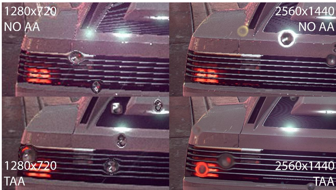
Figura 23 - Comparação entre o uso de Anti-Aliasing e resoluções de sintetização diferentes no jogo Need For Speed Heat (Ghost Games, 2019) (Imagem do autor).
